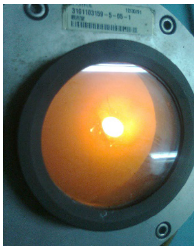
圖6 水冷卻坩堝真空感應電爐
