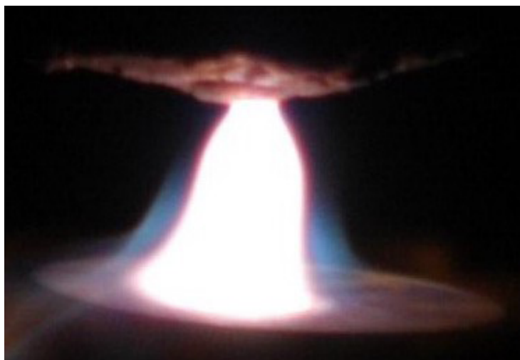
圖2 小型電漿精煉爐電弧
