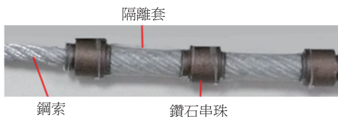
圖2 鑽石鋼索的組成與構造
