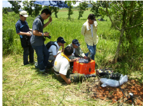
地熱潛能區大地電磁 MT 現場儀器設置作業
