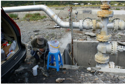
地熱水氣體化學採樣分析作業
