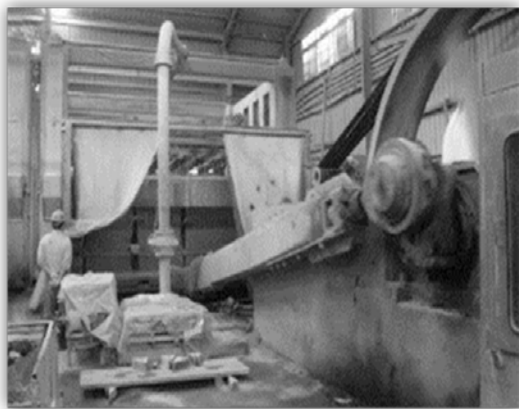
圖3 石材產業原石鋸切製程的升級與精進（左：鋼砂拉鋸 右：鑽石多索鋸）
