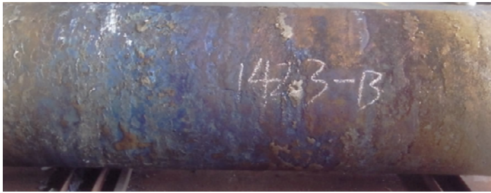
圖 6 VAR 鈦鑄錠高溫出爐造成之表面變色
